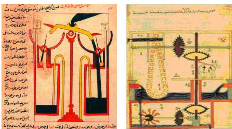
Рис.2. Схемы водоподъемных насосов
