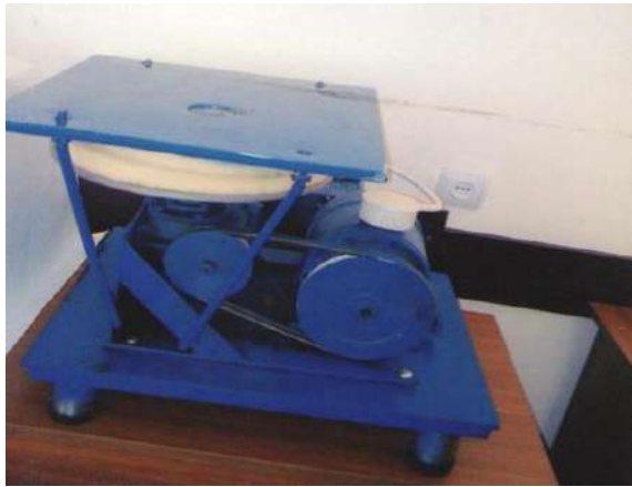
Şəkil 2. Lifli pambıq çiyidlərinin mərkəzdənqaçma qüvvəsinin təsiri ilə dərmanlanması üçün "Kirkirə" tipli qurğunun texnoloji sxemi a) və ümumi görünüşü: b); 1- dərmanlanma prosesində olan çiyid; 2- funqisid qabına salınmış paralon; 3- funqisid qabı; 4- elektrik mühərriki; 5;11- zəncir ötürməsi; 6;10;12-val; 7-friksion disk; 8- içliklə təmin olunmuş çiyidə mərkəzdənqaçma qüvvəsi verən səthinə rezin örtük çəkilmiş disk; 9- içliyin boşluğu; 13- çiyid bunker; 14-çiyid; 15- dərmanlanmış çiyid; 16- funqisid çəni; 17-nasos; 18- tıxacın çıxış deşiyi; 19- tıxacın boşluğu; 20- tıxac; 21- maye bölücüsü; 22;-çixış pəncərəsi
