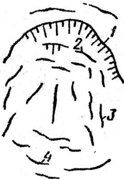
Şək. 1.16. Sürüşmə sahəsində daha xarakterik çatların yerləşməsi:
