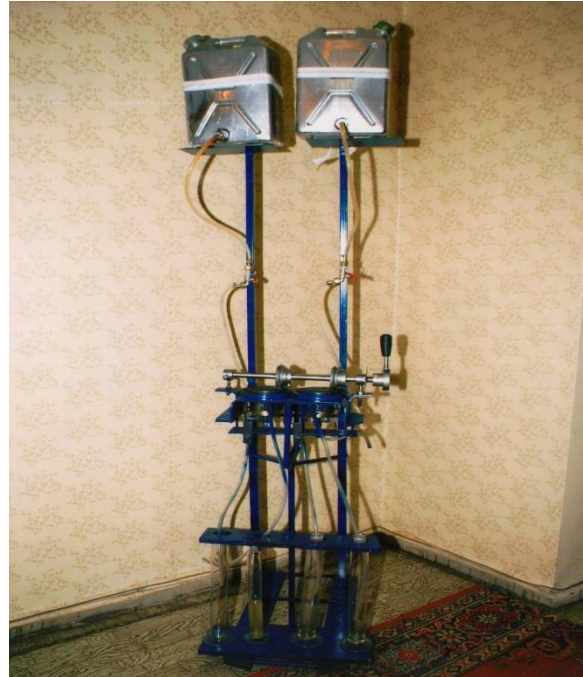
Şəkil 1. Müxtəlif qatılığa malik məhlulların hazırlanması üçün qurğunun ümumi görünüşü
