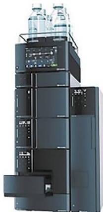
Şək.1. Neftin tərkibindəki aromatik karbohidrogenləri Yüksək Effektivli Maye Xromodinamika üsulu ilə təyin etmək üçün Nexera LC-40 Kompleksi.
