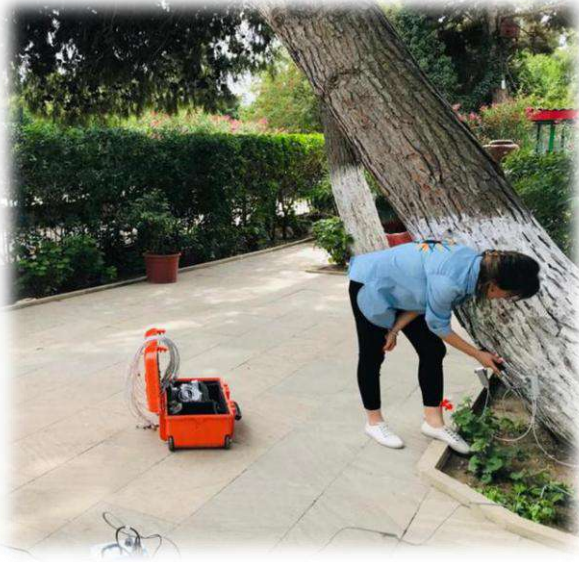
Şəkil 9. Arbotom cihazı vasitəsilə ağac gövdəsinin daxili tomoqrafiyası
