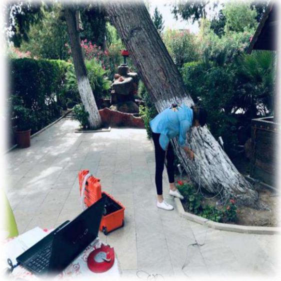
Şəkil 9. Arbotom cihazı vasitəsilə ağac gövdəsinin daxili tomoqrafiyası
