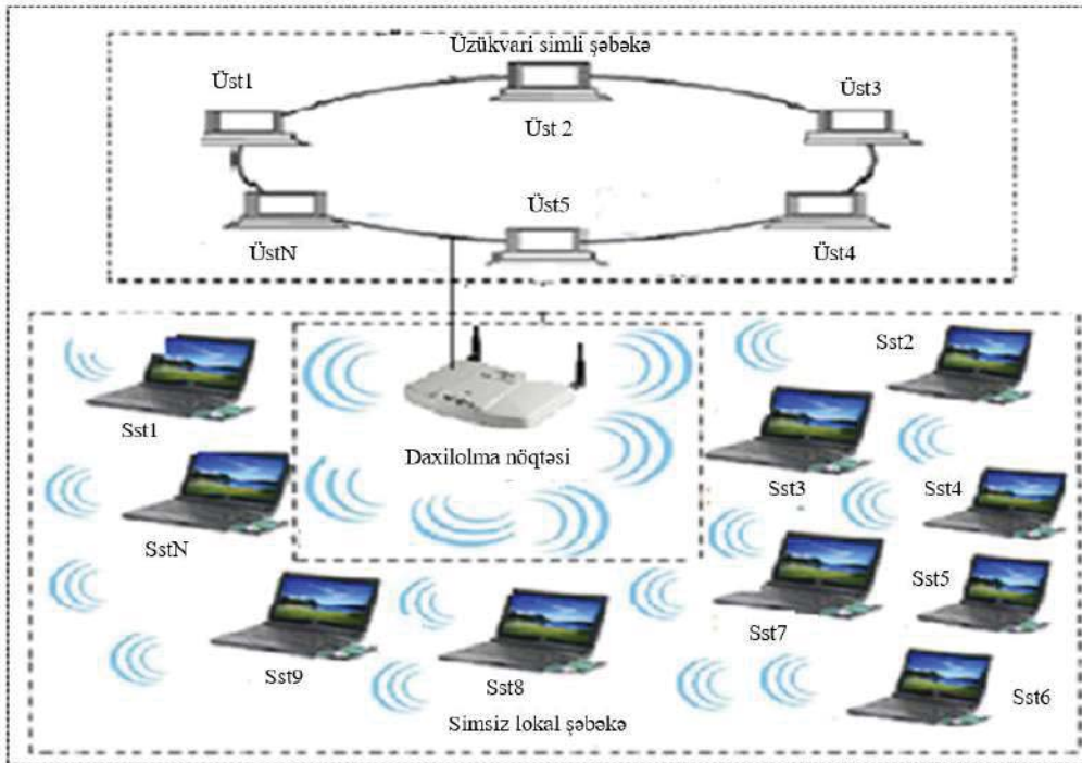
Şəkil1. Simsiz və simli lokal şəbəkə texnologiyaları bazasında simsiz lokal şəbəkələrin infrastruktur rejiminin funksional modeli
