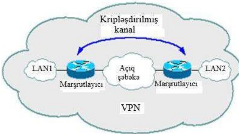
Şəkil 5.8. Lokal kompüter şəbəkələrinin marşrutlayıcılar üzərində qurulması sxemi
