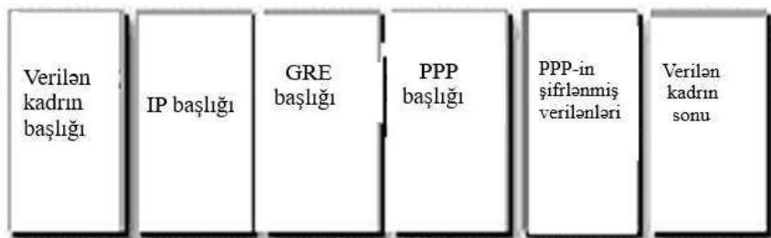
Şəkil 5.11. OSI modelinin kanal səviyyəsində mühafizə olunmuş kanalların yaradılması üçün istifadə olunan PPTP tunelləşmə protokolu üzrə ötürülən IP paketinin strukturu
