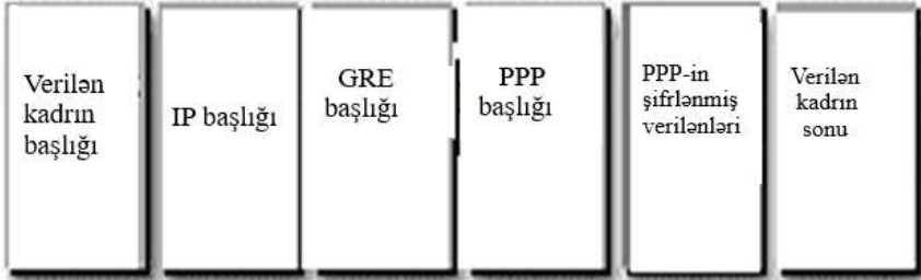
Şəkil 5.11. OSI modelinin kanal səviyyəsində mühafizə olunmuş kanalların yaradılması üçün istifadə olunan PPTP tunelləşmə protokolu üzrə ötürülən IP paketinin strukturu
