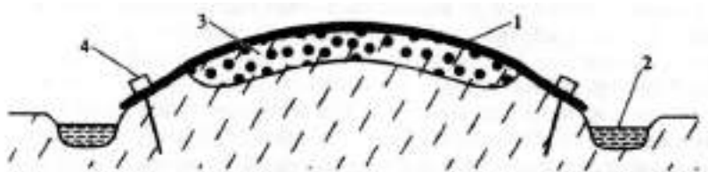
Рис. 20. Защитный поверхностный экран на загрязненном массиве: 1 - защитное покрытие; 2 - дренажная канава; 3 - очаг поверхностного загрязнения; 4 - крепление покрытия
