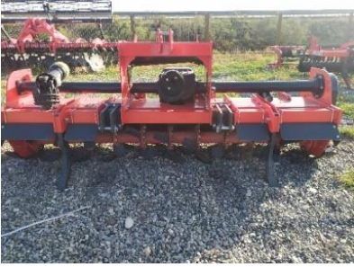
Rotorlu mala-torpaq hamarlayıcı Model: Köylü-2.8 (Koylu Turkish Company) En götürümü-2.8 m
