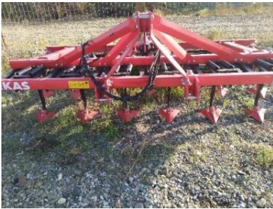
Çizel cultivator-yastıkəsən qazayağı işçi orqanlı Model: Köylü-3.5 m (Koylu Turkish Company) En götürümü-3.5 m
