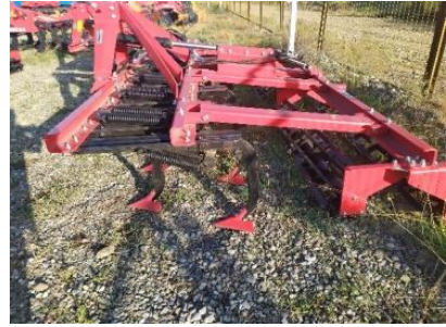
Çizel cultivator-yastıkəsən qazayağı işçi orqanlı Model: Köylü-3.5 m (Koylu Turkish Company) En götürümü-3.5 m
