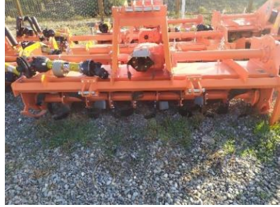
Rotorlu mala-torpaq hamarlayıcı Model: Köylü-2.8 (Koylu Turkish Company) En götürümü-2.8 m
