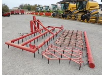
Ağır dişli mala Model: ADŞM En götürümü-4.2m, 4 ədəd ziqzaq mala ilə təchiz olunmuşdur
