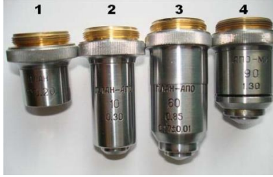
Şəkil 3. Mikroskopun obyektivləri: 1-planaxromat kiçik böyüdülmə üçün obyekt; 2 və 3 –planapoxromatlar; 4- immersion apoxromat
