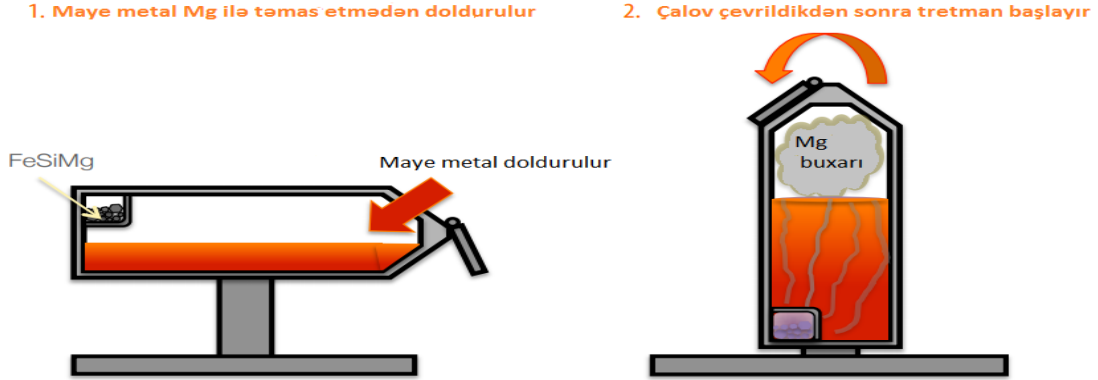
Şəkil. 4 konvertor üsulunun sistematik şəkili
