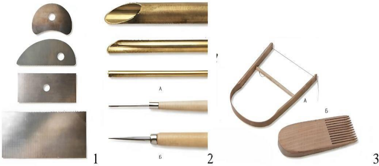
Şəkil 2. Dulus çarxda forma vermək üçün alətlər və qurğular:
